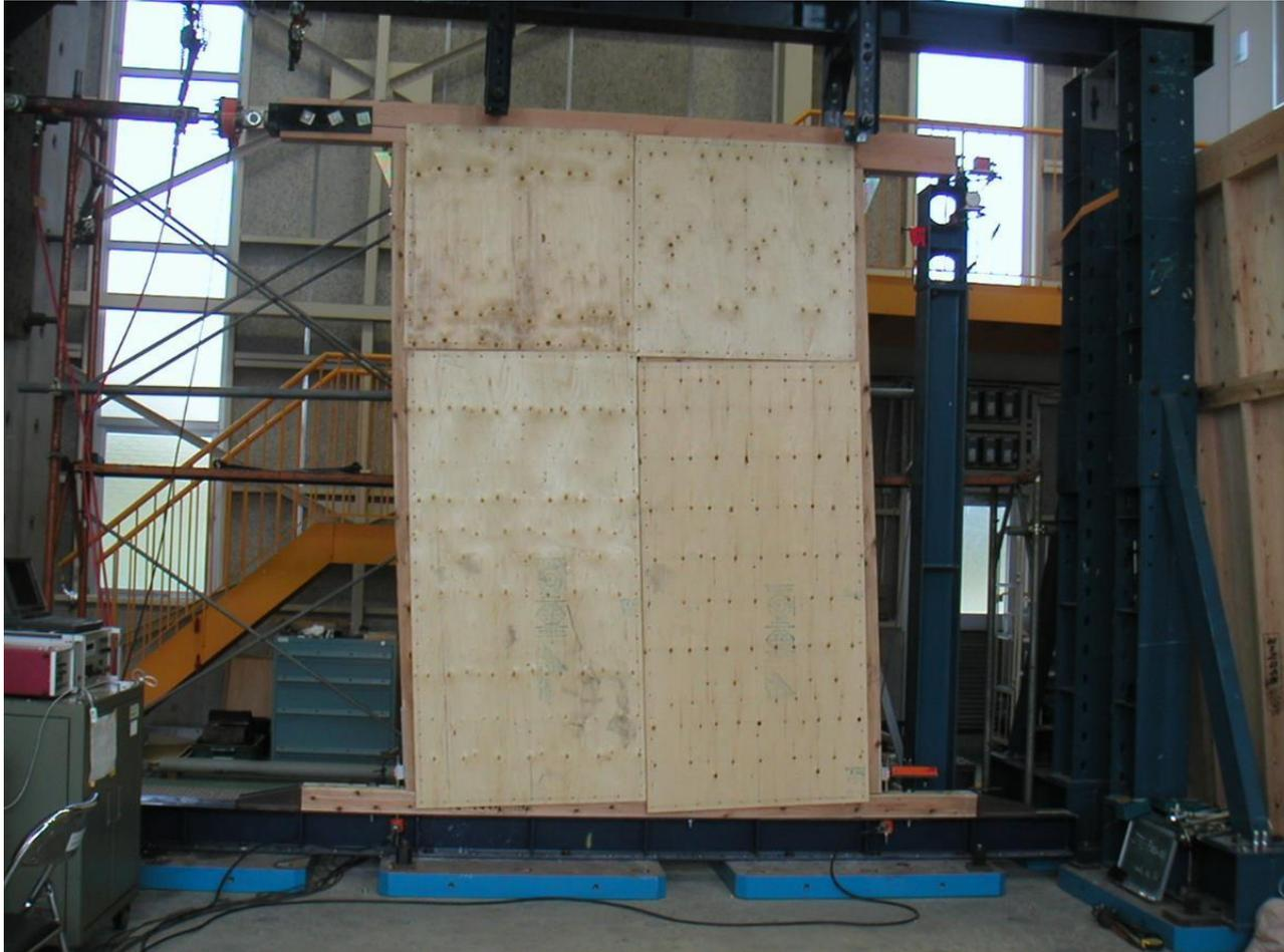
合板張り耐力壁の耐力評価実験
